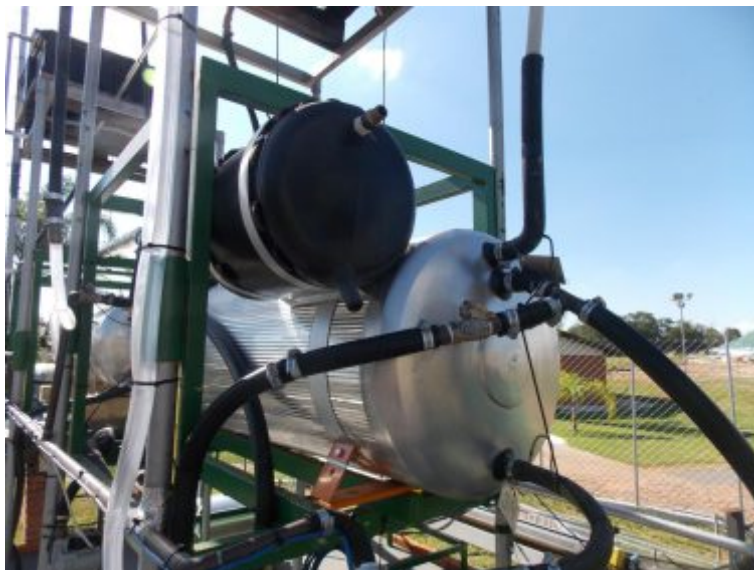
Figura A9: Detalhe do retorno de água quente no reservatório térmico do coletor plano.
