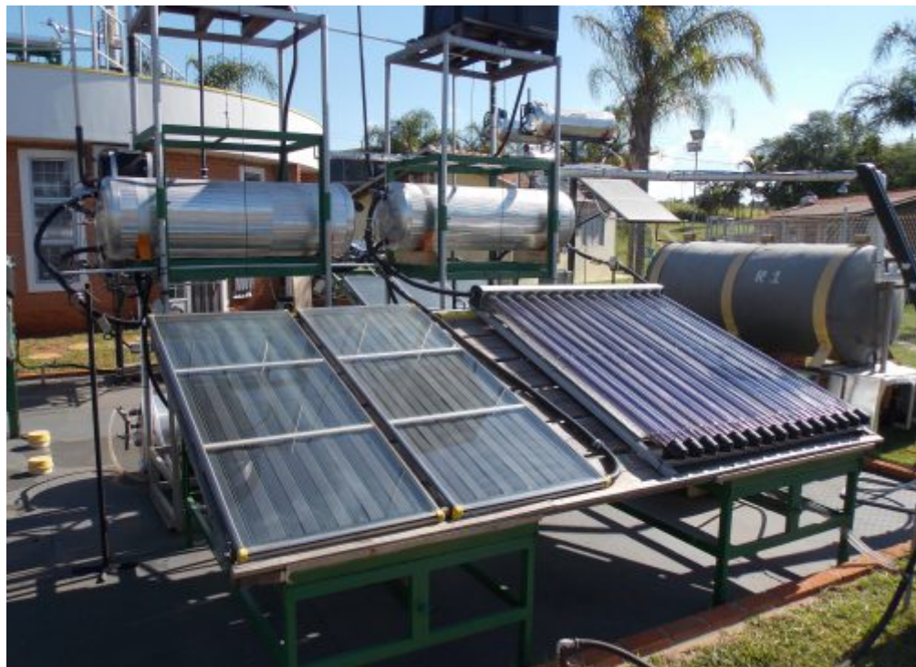
Figura 14: Sistemas de aquecimento utilizados nos experimentos com reservatório de apoio R1.
